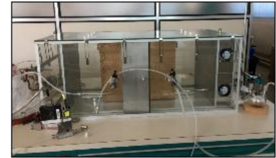
Test d'émissions en CLIMPAQ
