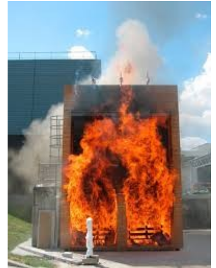
Incendie d'un bâtiment, embrasement de l'isolation thermique par l'extérieur.
