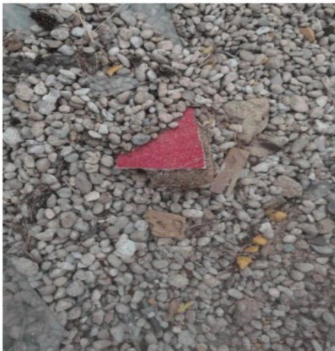
Prélèvement - P002 : RDC / Dallage - Plaque- (Présence d'amiante)
