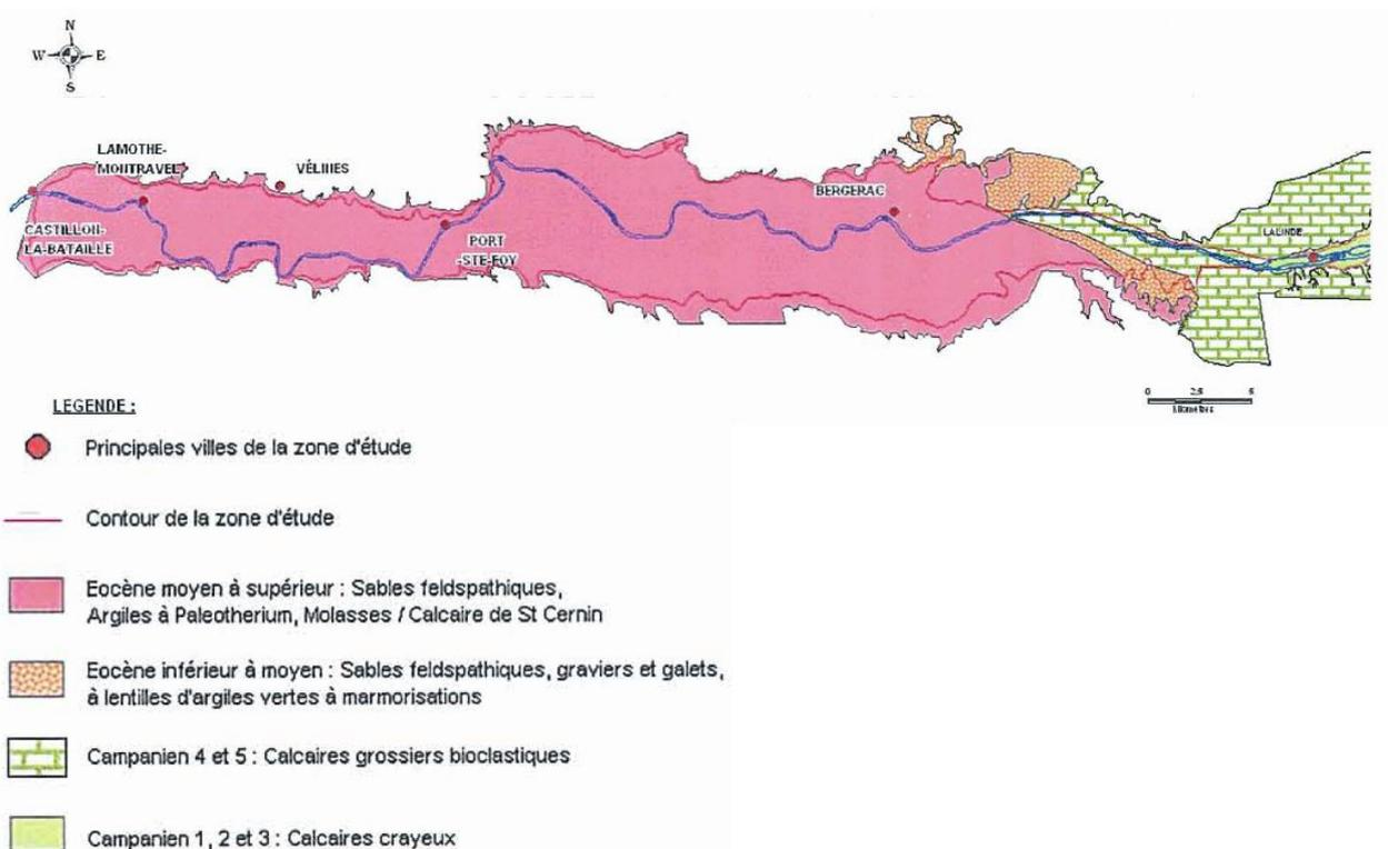
Illustration 9 - Représentation des différentes formations constituant le substratum de la nappe alluviale de la Dordogne [Saplaïroles et al., (2005)]
