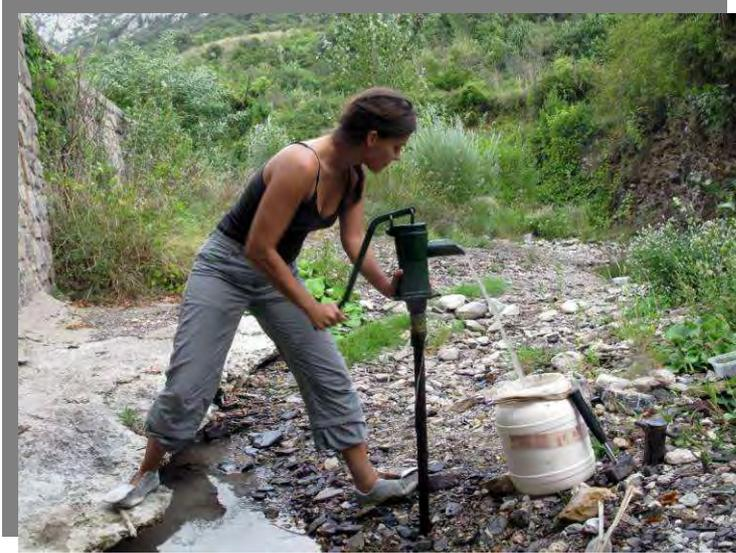
Pompage du sous-écoulement de Valunès à l'aide de la pompe Bou-Rouch.
