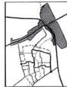
4- Les passages se hiérarchisent en voie principale en boucle, en voie secondaire et en cheminement piéton transversalement.
