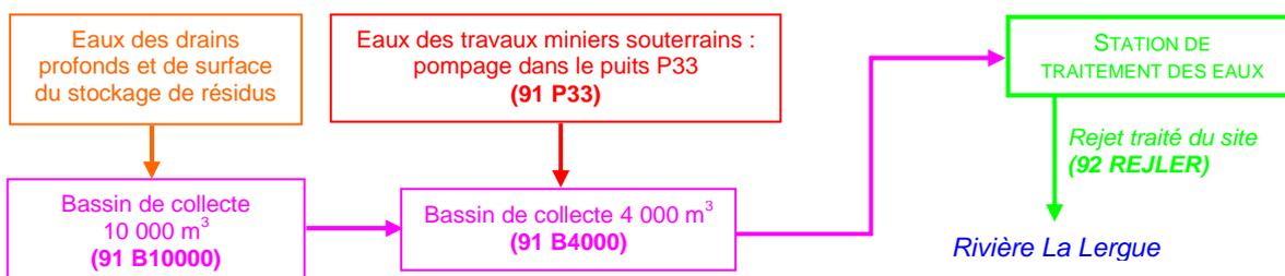
Les eaux provenant des travaux miniers souterrains sont pompées dans le puits P33 et sont analysées dans le cadre de l'autosurveillance d'AREVA. Elles présentent les caractéristiques radiologiques et physico-chimiques suivantes :
