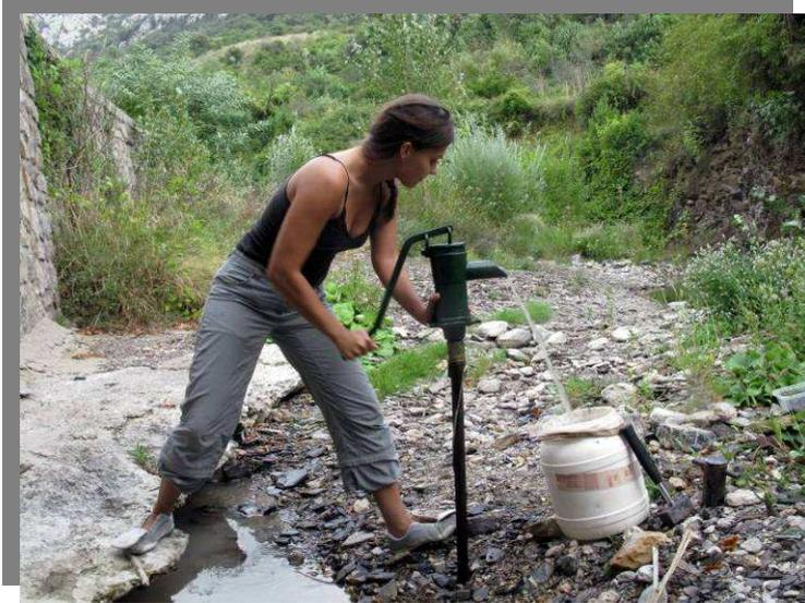
Photo 3 : Pompage du sous-écoulement de Valunès à l'aide de la pompe Bou-Rouch (Biotope)
