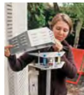
Portoir installé à l'extérieur pour mesurer le monoxyde de carbone, les composés organiques volatils et les aldéhydes.
