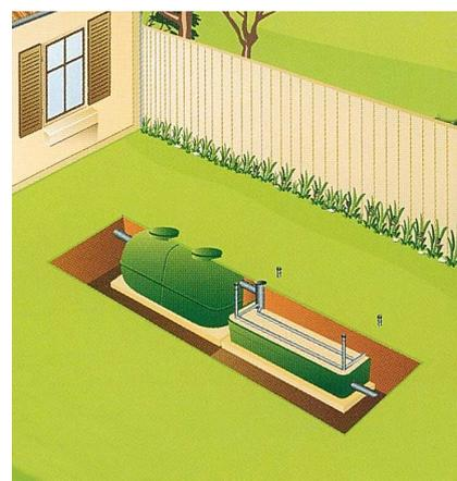
Ce dispositif nécessite un exutoire compatible (*fossé, réseau eaux pluviales*) car la perte de charge est de 1 m. Il ne peut être utilisé lorsque des usages sensibles tels que la baignade ou la conchyliculture existent à proximité.
