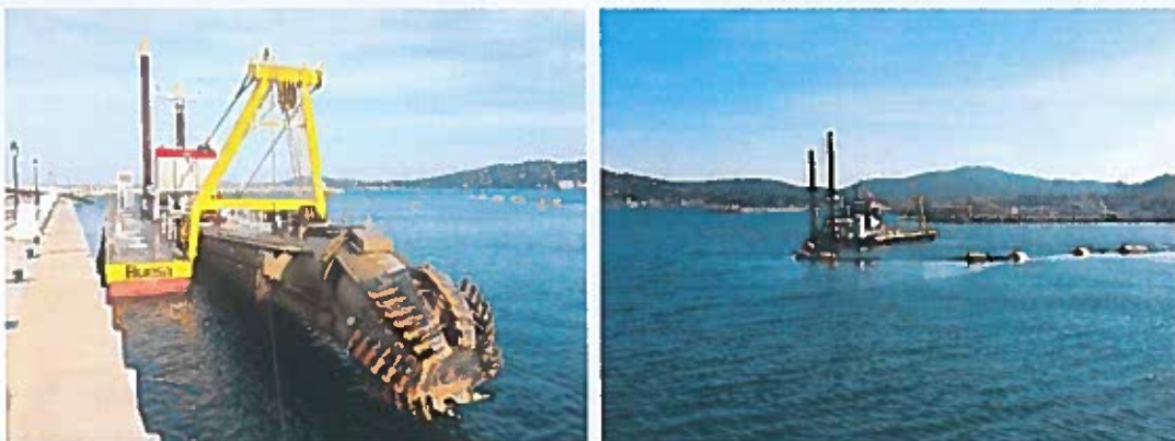
Exemple d'une drague aspiratrice stationnaire et sa conduite de refoulement
