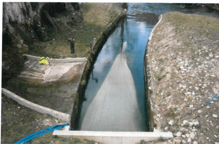
Figure 4 : Test d'ichthyocompatibilité avec filet de piégeage en aval de l'aspirateur sur site en Ariège (solution DIVE)
