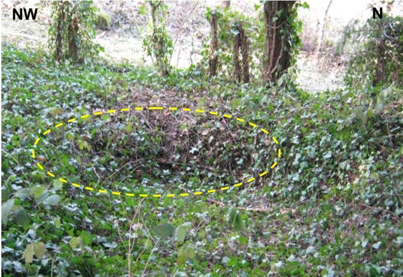
Tassement de terrain (Ø 5.2 m et 20 cm de profondeur) situé à 15 m au NW du puits et dans l'alignement des anciens travaux miniers
