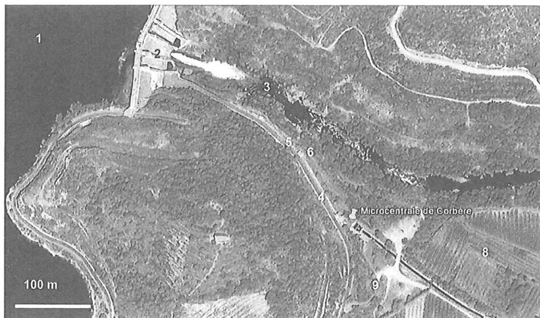
1 : réservoir de Vinça ; 2 : barrage de Vinça ; 3 : Têt ; 4 : route goudronnée d'accès vers barrage ; 5 : conduite forcée ; 6 : ripisylve composée de peupliers et robiniers ; 7 : canal de Corbère ; 8 : champs de pêche ; 9 : route goudronnée d'accès à l'ouvrage brise-charge de Corbère
