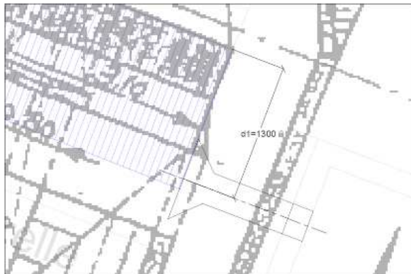
Figure 9: Implantation de l'échancrure dans le bajoyer RD
