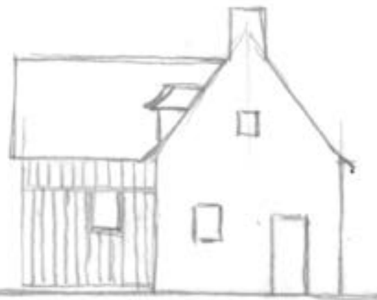
Bardage vertical + couvre-joint
