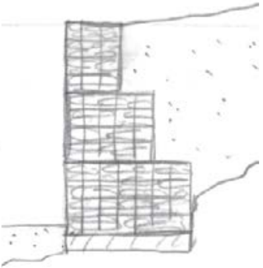
Mur de soutènement en gabion
