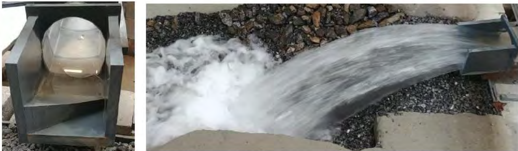
Figure 19 : Vues du saut à ski sur modèle réduit (à droite : jet avec dissipation d'énergie à la crue de projet – source SHEM)
