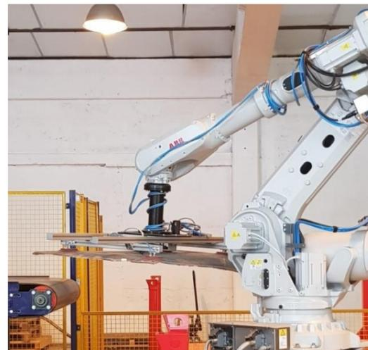
☞ Photographie 5 : Chargement du modules laminés avant découpage, broyage et séparation des éléments des modules
