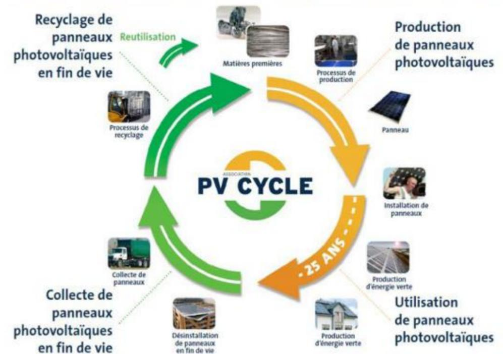
☞ Figure 2 : Cycle de vie des panneaux photovoltaïques en silicium cristallin
