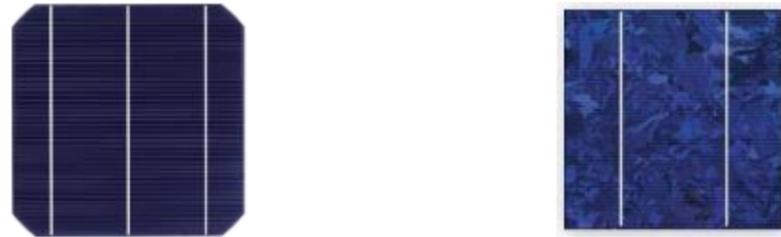
☞ Figure 5 : Cellule au silicium monocristallin (gauche) et polycristallin (droite)
