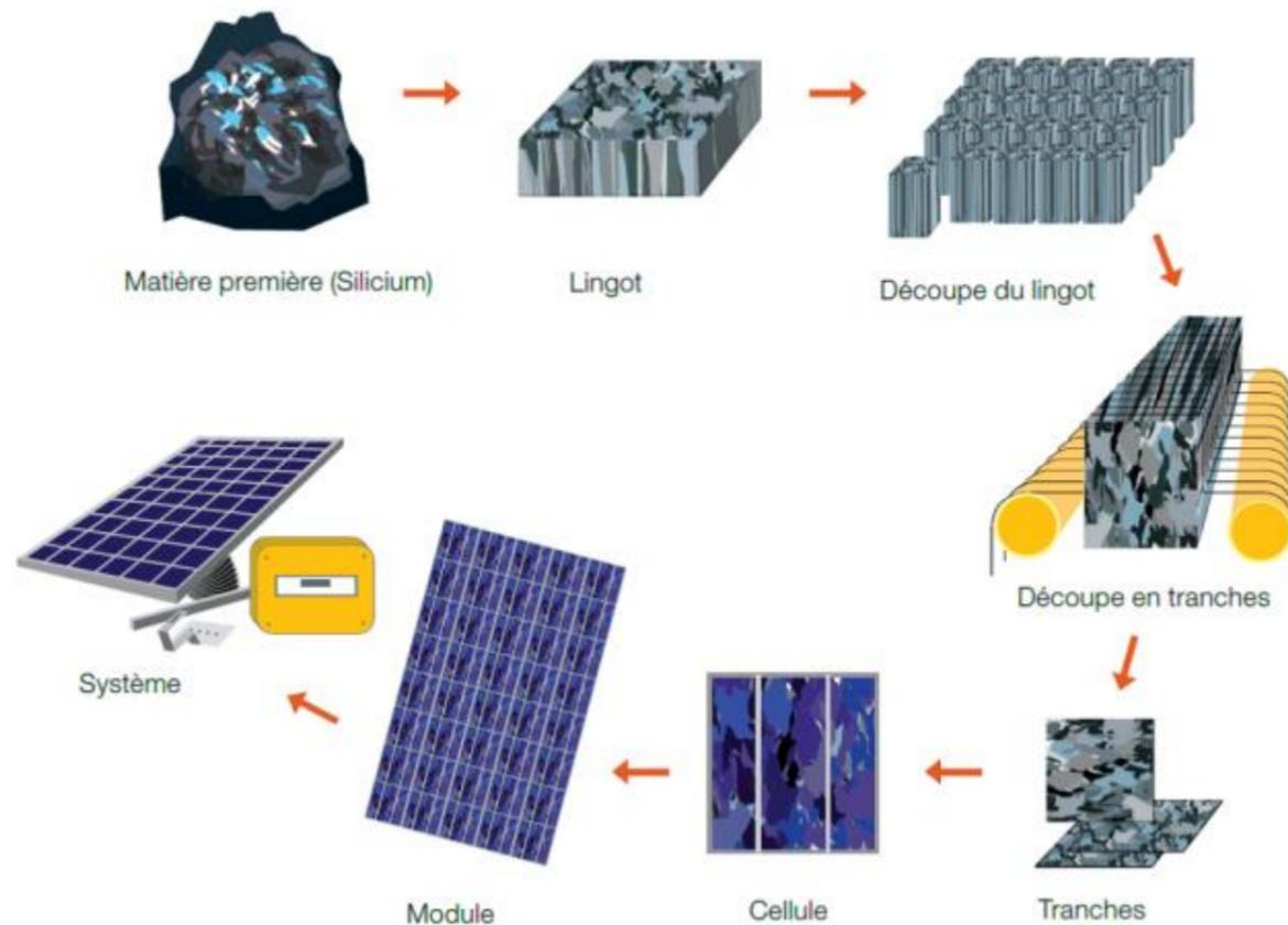
☞ Figure 6 : Procédé de fabrication d'un système photovoltaïque (technologie cristalline)<sup>2</sup>
