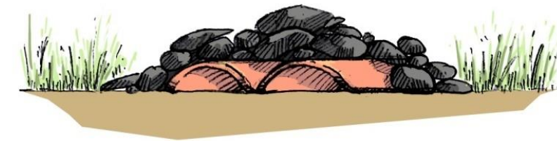
☞ Figure 48 : Exemple de pierrier sur tuiles canal – CRBE
