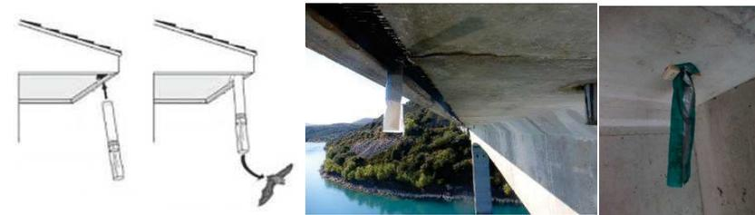
Illustrations de dispositif anti-retour à mettre en place à hauteur des potentialités identifiées (Sources : schéma - GCG, 2014 ; photos - Naturalia)
