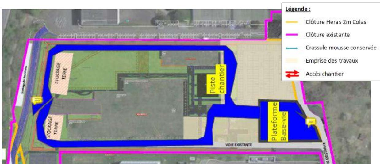
Figure 8 : Installations de chantier
