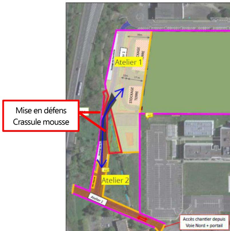
Figure 7 : Préparation accès chantier et démarrage des réseaux avec protection des stations de la Crassule (en rouge)
