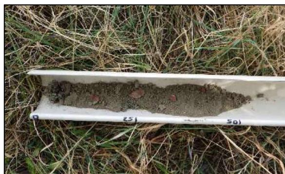
Figure 25 : Remblai composé de limons et briques
