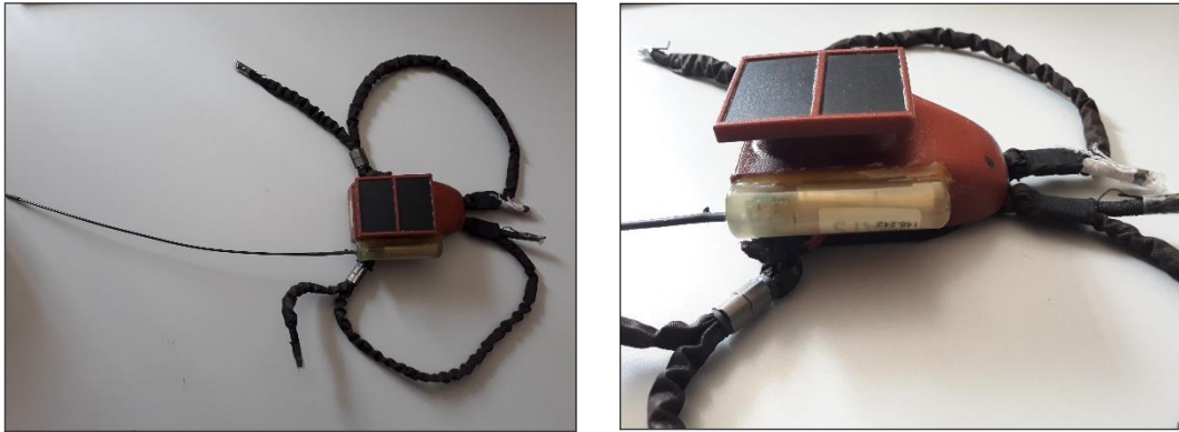
Figure 33 : Une balise GPS/GSM Ornitela et l'émetteur VHF collé dessus – © Noémie Ziletti
