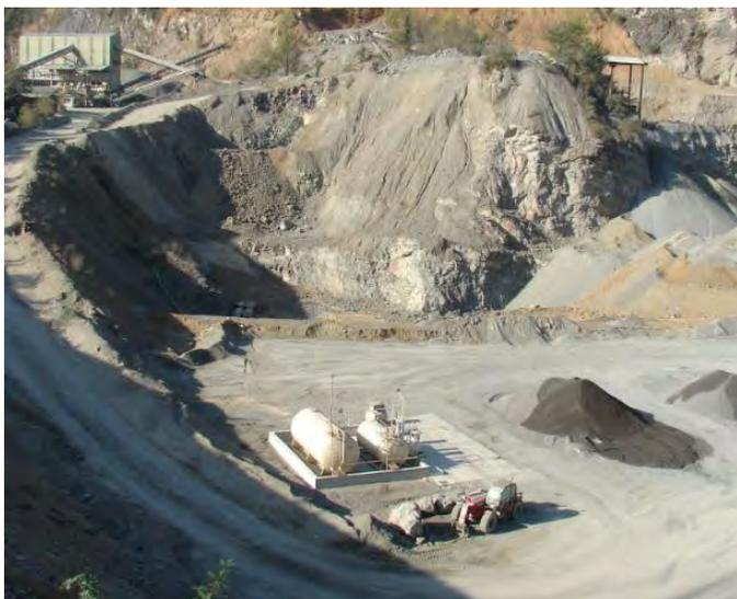
*Cuves de gazole non routier (GNR) et gazole routier sur rétention dans la zone nord de la carrière (photo SOE)*
