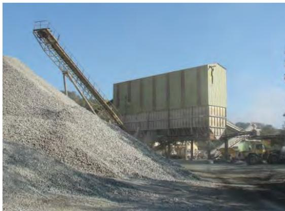
*Concasseurs secondaire et tertiaire et crible
