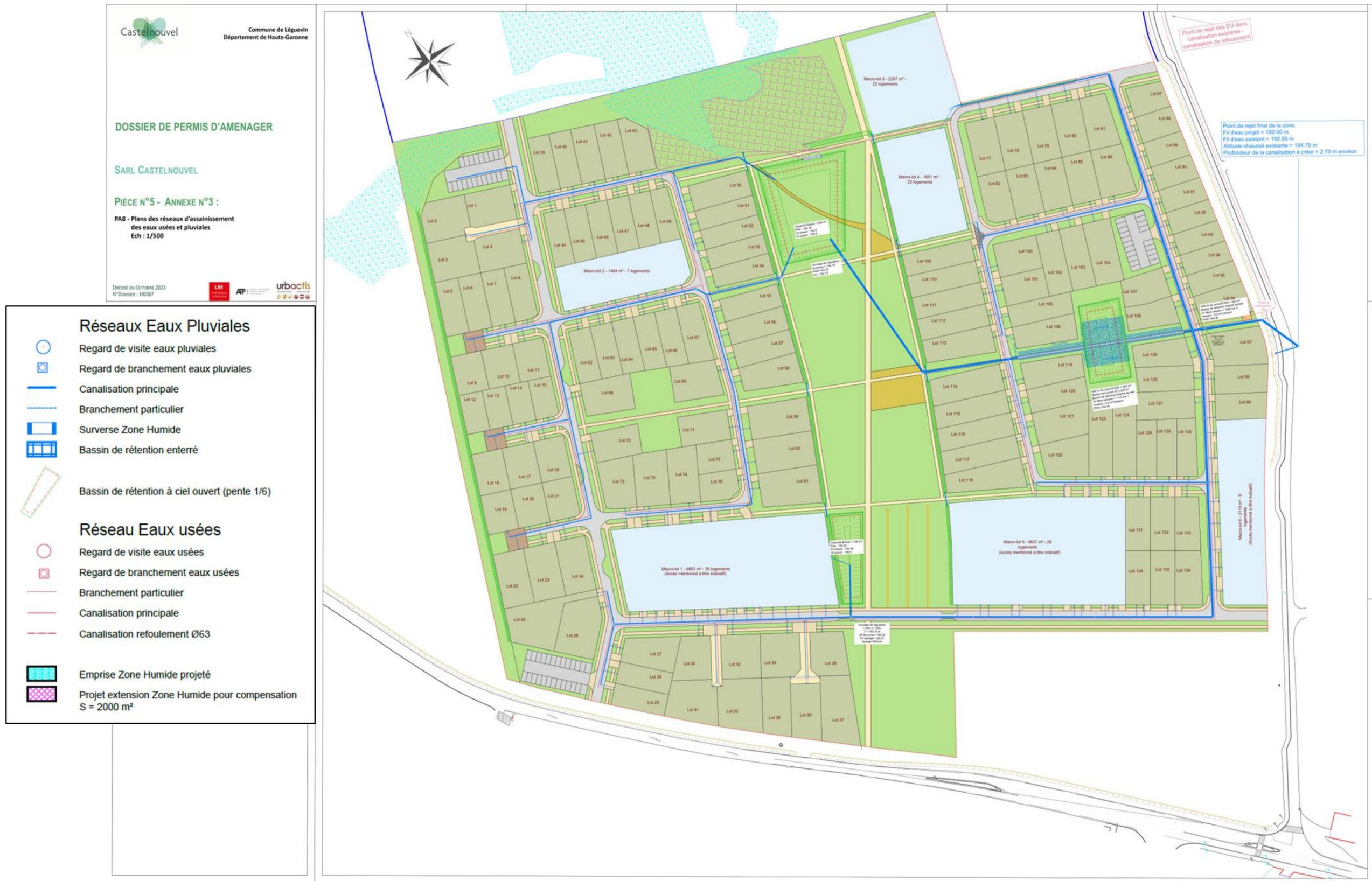
Figure 18 : Plan de gestion des eaux pluviales (et d'assainissement eaux usées) du projet (Source : Cabinet de géomètres expert Urbactis)
