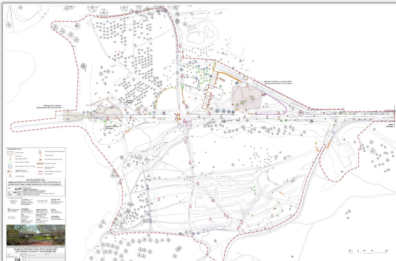
Carte 5 : Localisation des démolitions des ouvrages existants, des aménagements à déposer et des arbres à abattre dans le cadre du projet (IDE, 2022)
