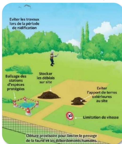
Figure 31 : Exemples de mesures de chantier (Source : ONCFS)
