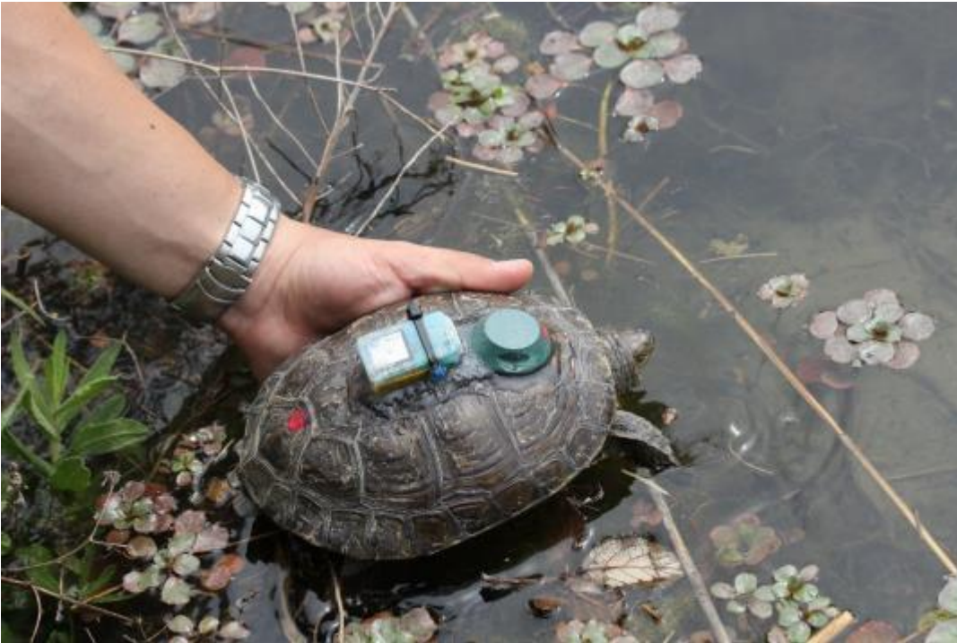
Figures 3&4. GPS utilisé pour cette étude pour une masse finale inférieure à 20 grammes. L'ensemble est fixé sur la tortue par un serre-joint plastique passé sous une grille plastique (encollée sur la carapace avec de résine époxy prise rapide), qui en permet le retrait aisé sur le terrain. La grille et la résine sont facilement retirées à la main.
