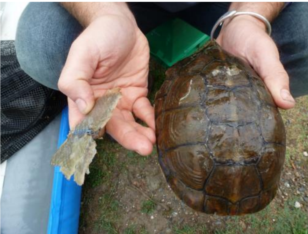
Figures 3&4. GPS utilisé pour cette étude pour une masse finale inférieure à 20 grammes. L'ensemble est fixé sur la tortue par un serre-joint plastique passé sous une grille plastique (encollée sur la carapace avec de résine époxy prise rapide), qui en permet le retrait aisé sur le terrain. La grille et la résine sont facilement retirées à la main.
