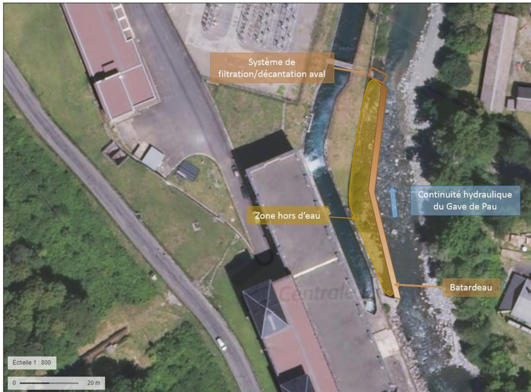
Figure 14 : Schéma de principe de l'isolement hydraulique sur le site de Luz
