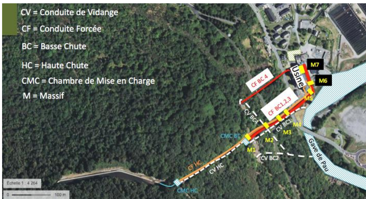
Figure 3 : Localisation de l'ouvrage
