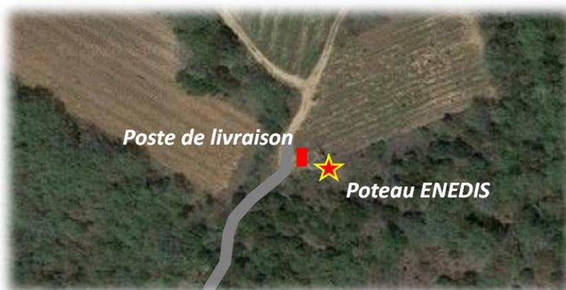
Le raccordement au réseau ENEDIS s'effectuera au plus proche des infrastructures existantes à proximité du terrain, avec un piquage sur la ligne HTA surplombant le nord du site.
