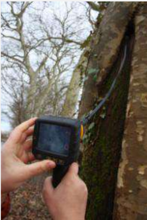
Visite d'une cavité à l'aide d'un endoscope
