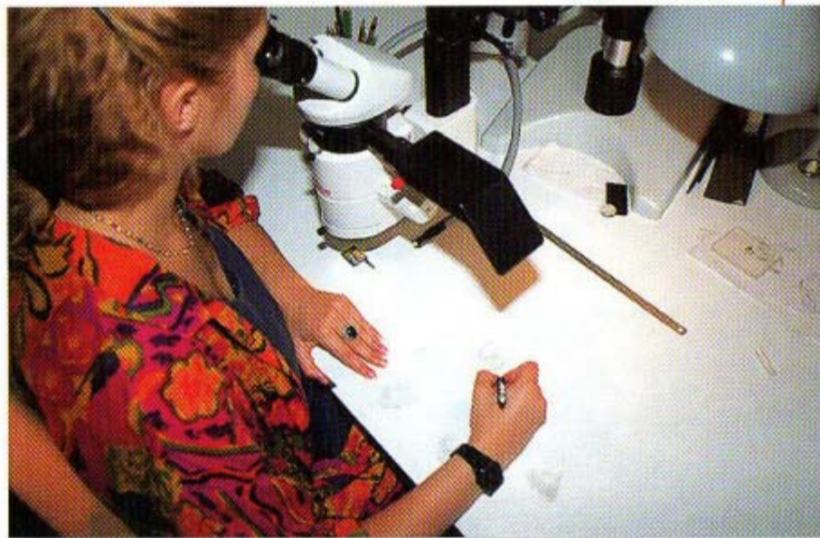
Une petite dent est dessinée sous une loupe binoculaire équipée d'une chambre claire.
