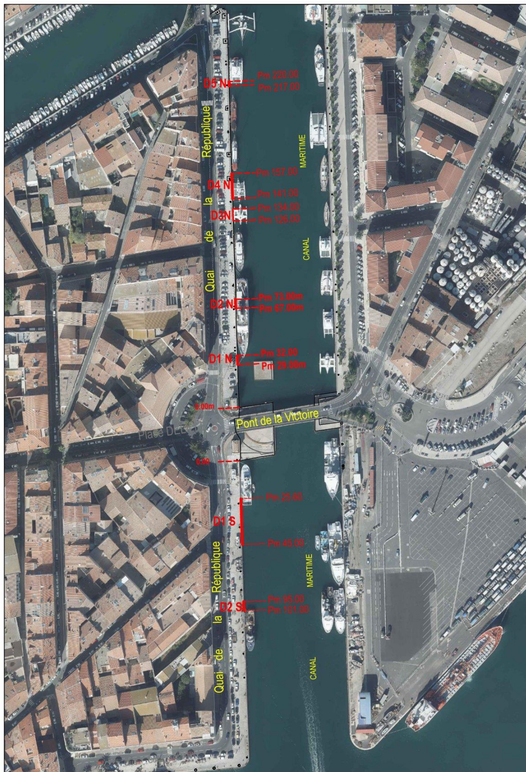
Figure 6 : Localisation des dégradations au quai de la République
