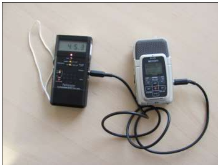
PETTERSSON D240X couplé à un enregistreur numérique
