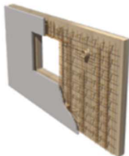
Mur à coffrage intégré isolant
