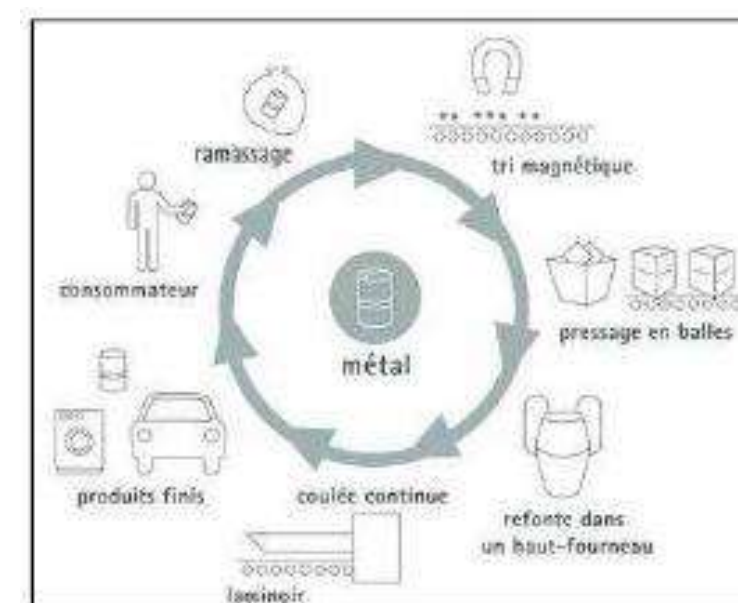
Figure 2 : Recyclage des structures porteuses
