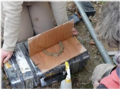
1/ Positionnement de la base de barbotine sur le bois humide de l'équerre
