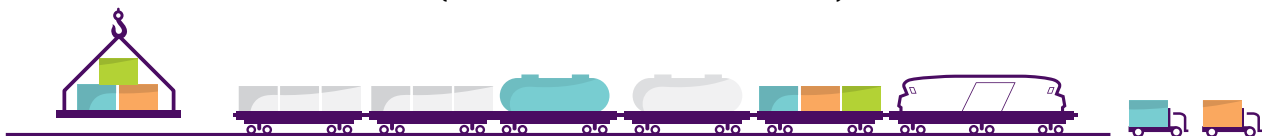
Le transport combiné terrestre « classique » emploie plusieurs types de conteneurs, semi-remorques, caisses mobiles
