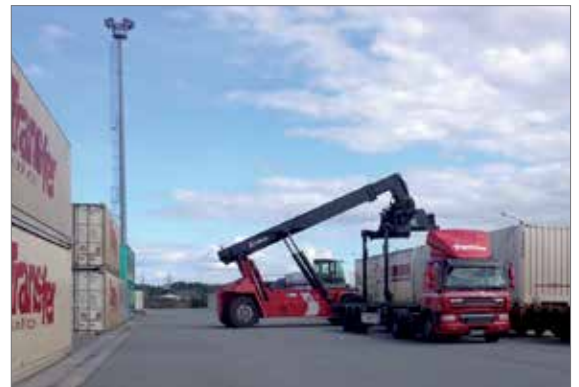
Chargement d'une caisse-mobile par reach-stacker / photo: SYSTRA
