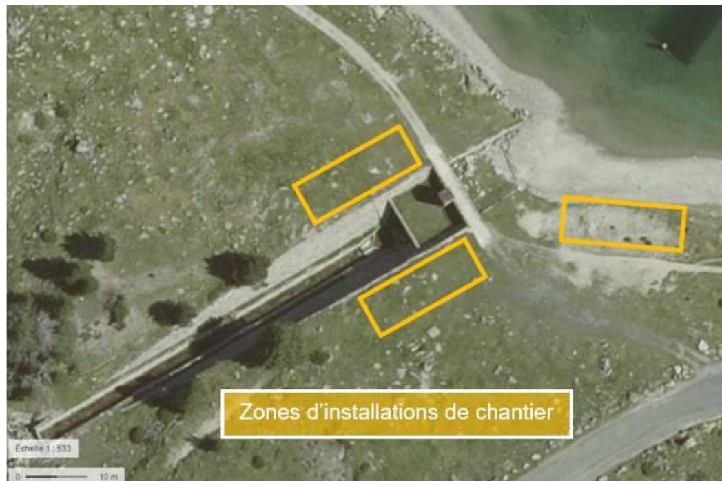
Figure 31 : Zones d'installations de chantier (stockage, base-vie) au barrage d'Aumar
