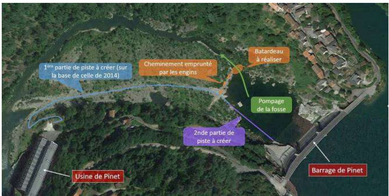
Figure 6 : Schéma de principe des accès, du batardage et de la mise à sec de la fosse
