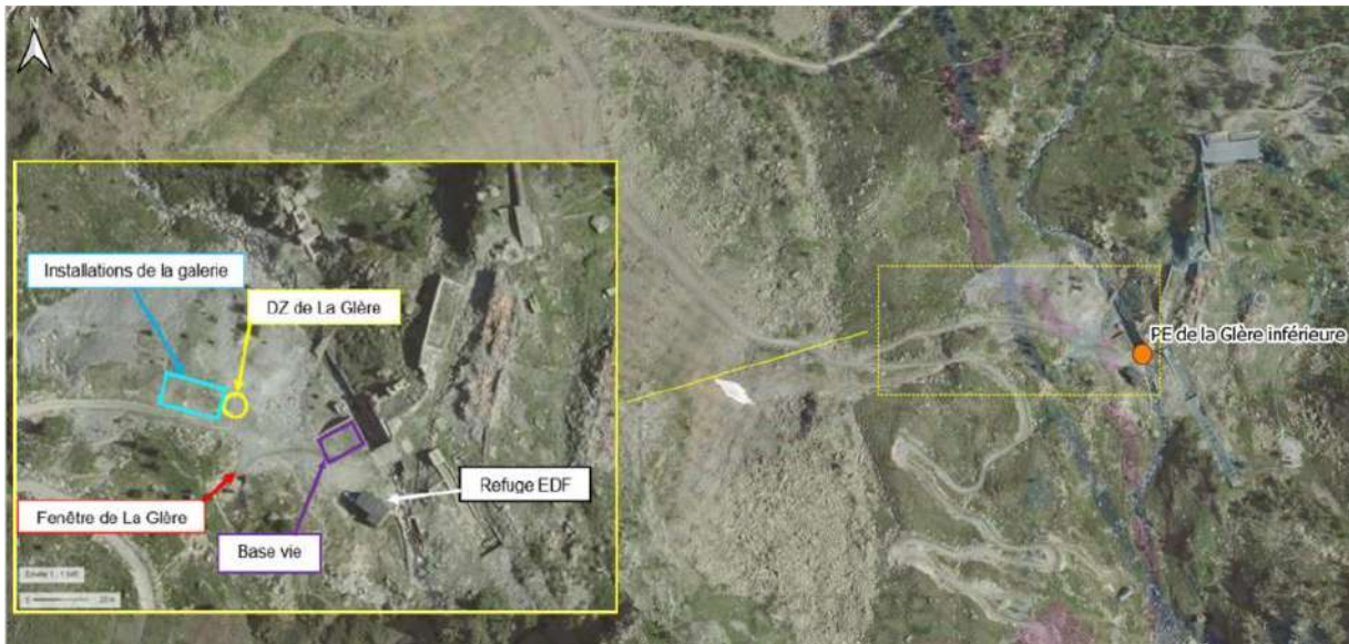
Figure 108 : Localisation des installations de chantier sur la plateforme de la PE de la Glère inférieure
