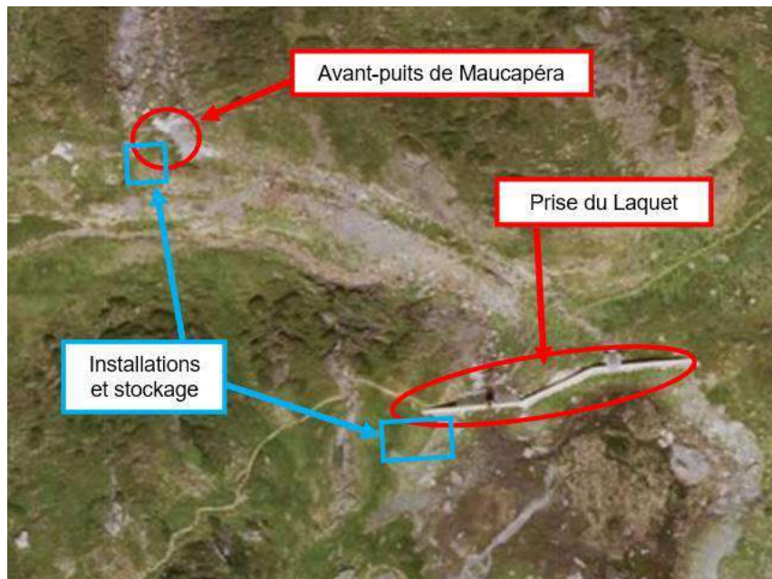
Figure 98 : Localisation de l'installation de chantier au niveau de la PE de Maucapéra inférieure et de l'avant puits
