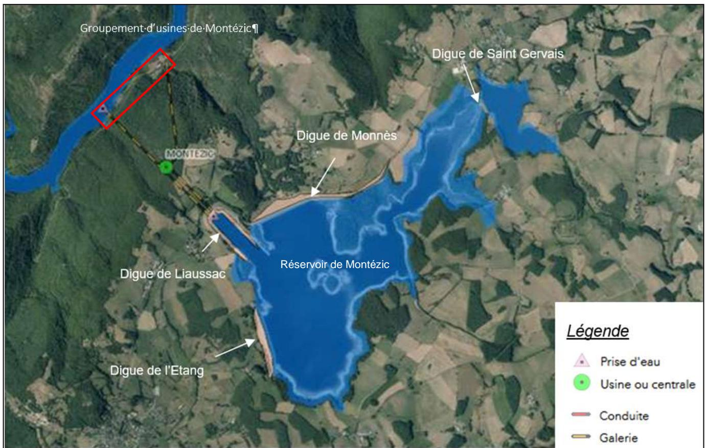
Figure 2 : Plan d'implantation de l'aménagement de Montézic et emprise globale des travaux (en rouge) (source : EDF)
