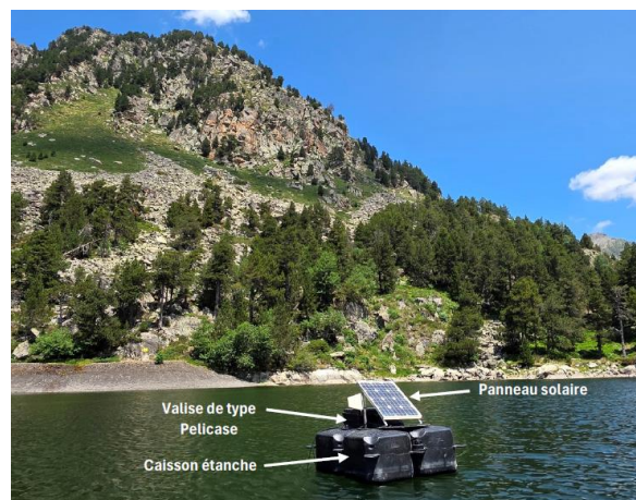
Figure 15 : Station de mesure flottante installée (source Tétraèdre)
