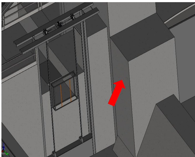
Figure 36 : Proposition d'implantation échelle limnimétrique dévalaison RD
