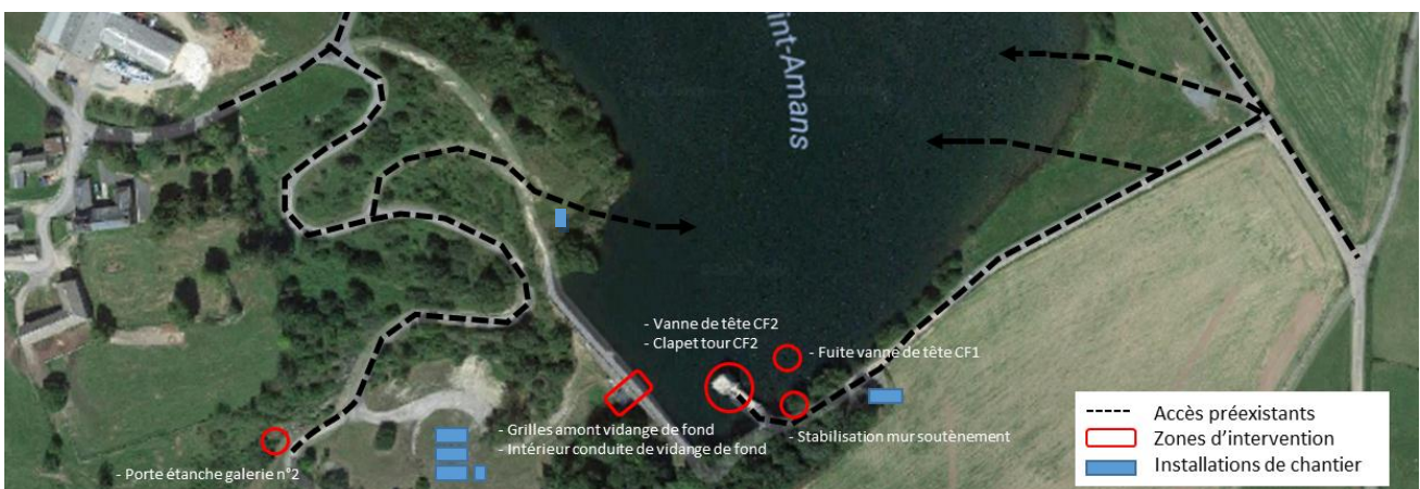
Figure 23. Accès et installations de chantier à Saint Amans.
