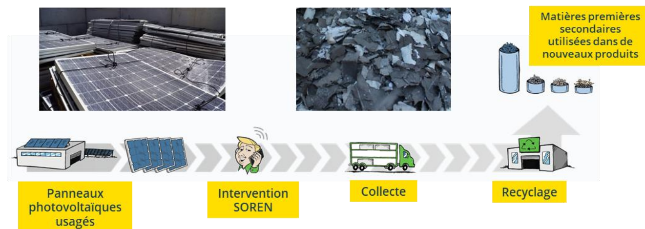
Figure 33 : Circuit de recyclage d'un panneau
