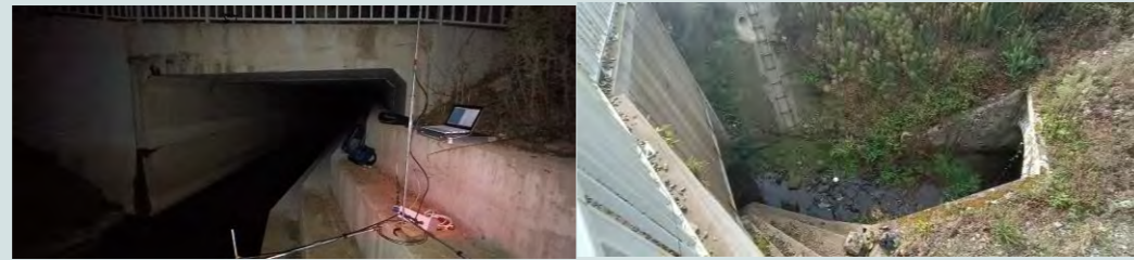
Photos 2 - Dispositif de trajectographie 3D sur ouvrage hydraulique jumelé pour définir les trajectoires de Grand Rhinolophe (© Egis - 2022)
