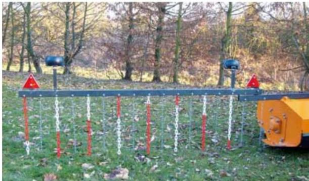
**Figure 54 : Exemple de barre d’effarouchement**
