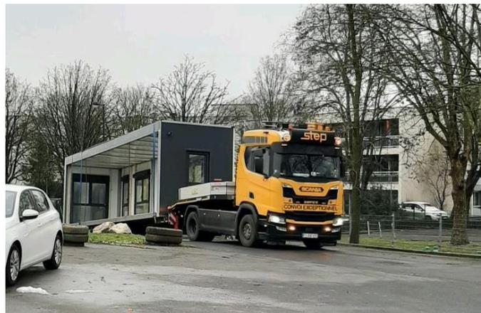
Transport d'un module métallique
