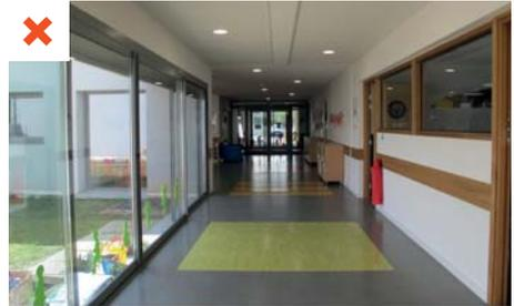
Plancher chauffant traditionnel en fonctionnement lors d'une journée ensoleillée. Les apports solaires vont se cumuler aux calories diffusées par le plancher et créer une surchauffe. De plus, même si le chauffage est coupé en début de matinée, le plancher reste trop chaud pour pouvoir valoriser de façon optimale les apports solaires.
